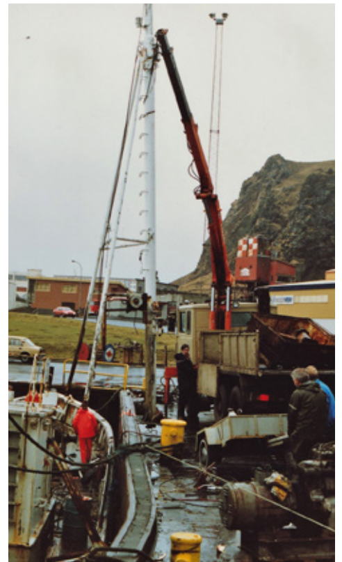
Frammastur hift upp á bryggju. Aðalvél, ljósavél og lestarlúga komið upp á bryggju
